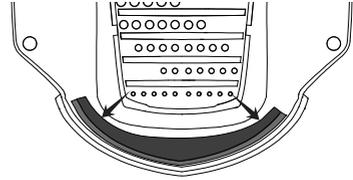
(Opsional) Anda bisa menempelkan 2 stiker di bagian bawah masker seperti gambar di atas untuk mencegah udara keluar dari bagian bawah masker.
