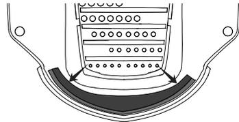
(可选) 您可以按照上图指示将海绵粘在面罩底部，以防止漏气。
