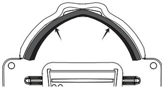
将顶部海绵粘在鼻梁上，以防止空气从鼻子区域泄漏
